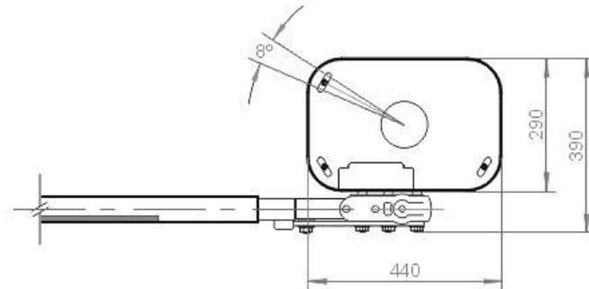
La barrera se monta según el sentido de circulación del tránsito. El soporte del brazo debe quedar detrás, como muestra la siguiente figura.
