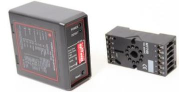
La espira es parte de un circuito oscilador que genera un campo magnético. Al ser atravesado por el vehículo se produce un cambio en la frecuencia del oscilador. Esta variación es detectada por un circuito con microprocesador que determina, en base a la configuración del equipo, si debe producir o no la señal de salida.
